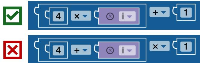
**Erklärung:** Der innere Block funktioniert wie eine Klammer.
